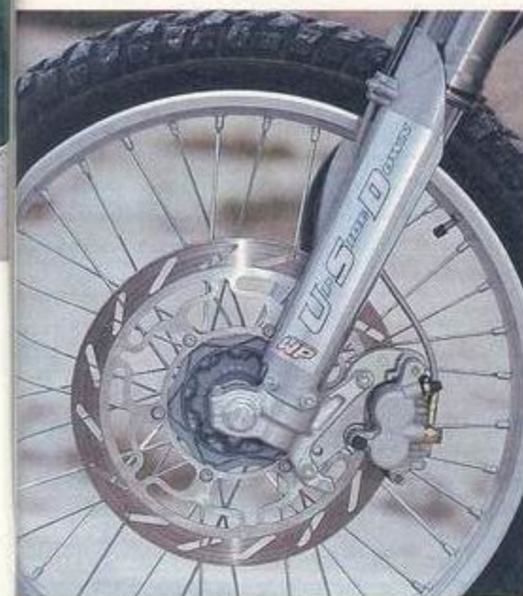
Gut gerüstet: 300-Millimeter-Bremsscheibe, Motor mit Elektro- und Kickstarter. Allerdings nur mit Hauptständer lieferbar
