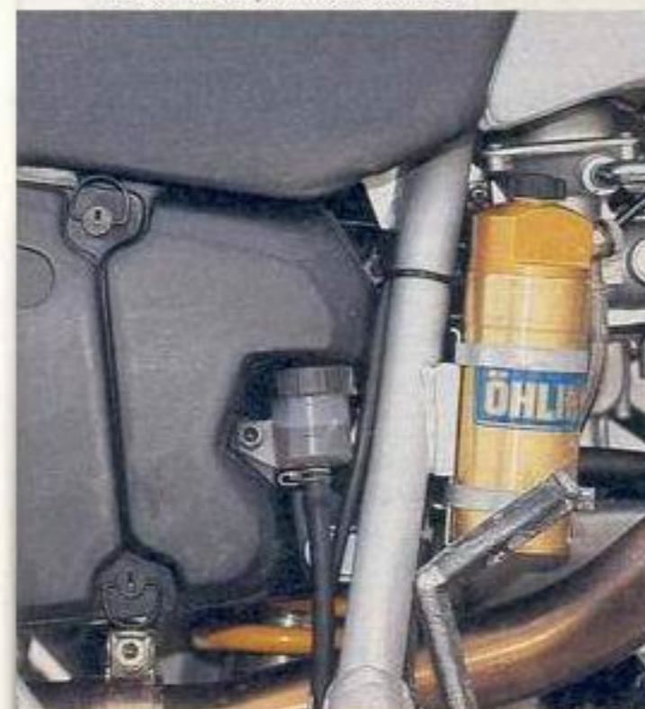
Mitgedacht: Ölkontrolle durch ein Schauglas, Luftfilterdeckel mit Schnellverschlüssen, Öhlins-Federbein
