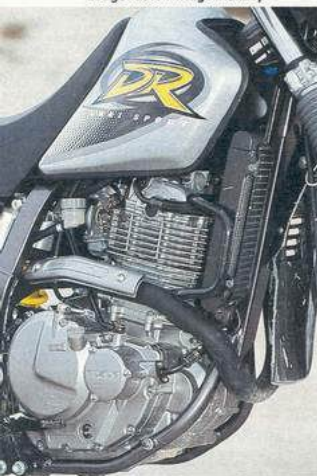
Ölkühler mit Sturzschutz, spartanische Anzeigen, alles gut zugänglich und das überzeugendste Alltags-Konzept
