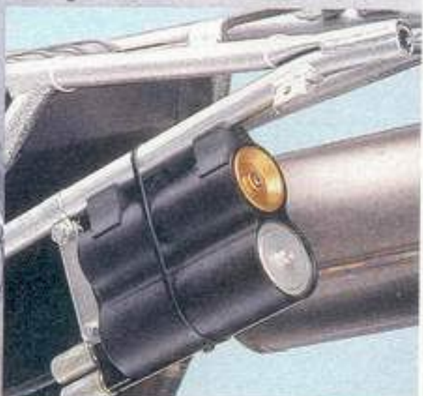
Am Rahmenheck sitzt der Ausgleichsbehälter des Hydrauliksystems
