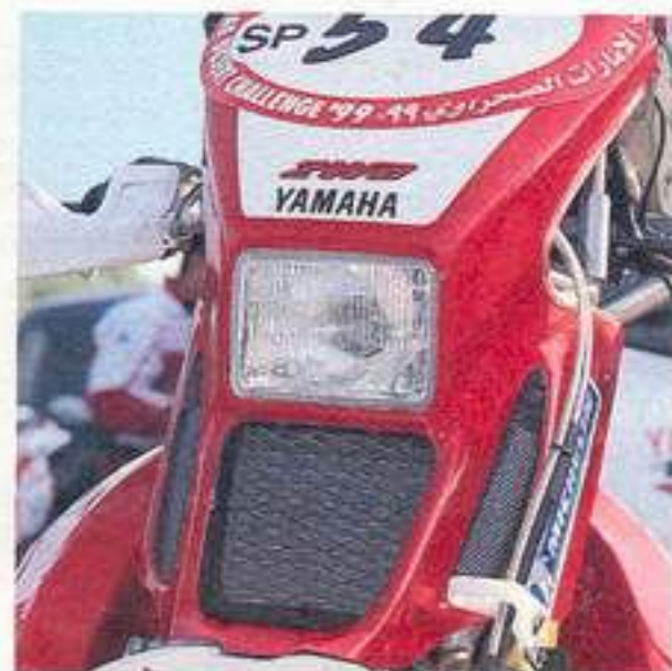
Serienmäßig: Dieser Kühler senkt die Motoröl-Temperatur der luftgekühlten TT 600 R 2WD
