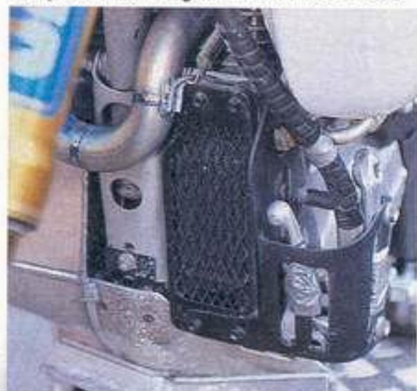
Spezialanfertigung: Der Kühler vor dem Motor gehört zum Allrad-Antrieb
