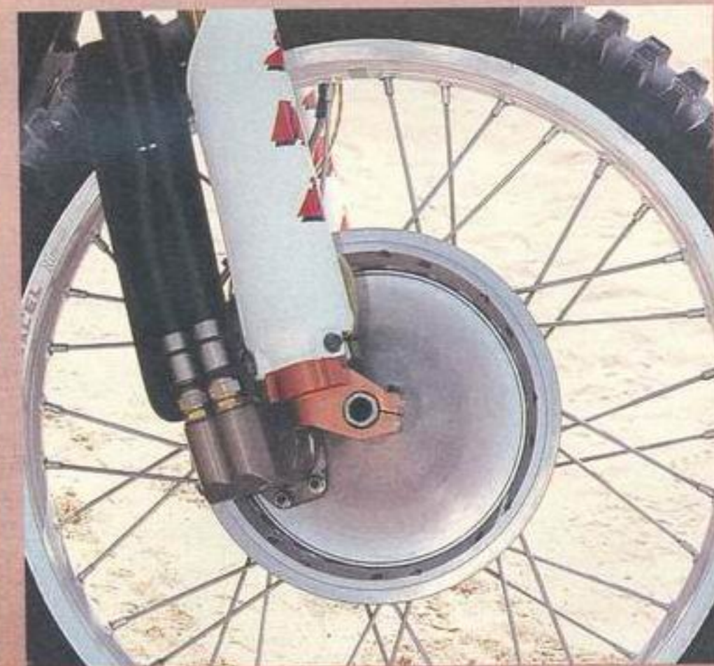
Der Hydraulikmotor befindet sich auf einer speziellen Ankerplatte und ist in die Vorderradnabe integriert. Er treibt über eine Verzahnung in der Nabe das Vorderrad an
