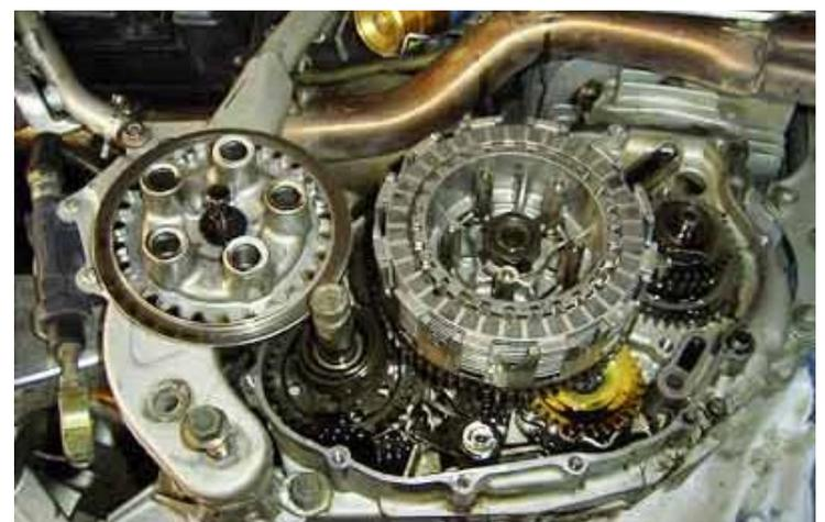
Beim Einsetzen drauf achten, in welcher Reihenfolge die alten Scheiben eingesetzt waren.
